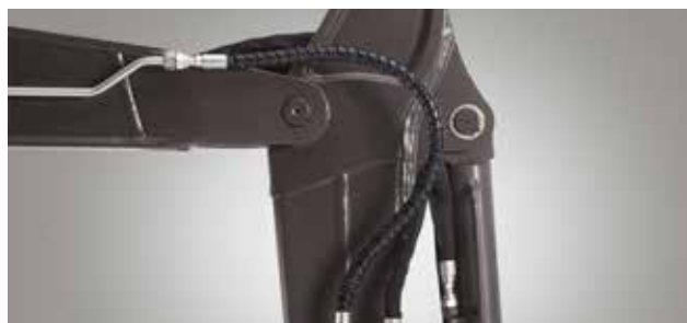
Circuit hydraulique auxiliaire secondaire
